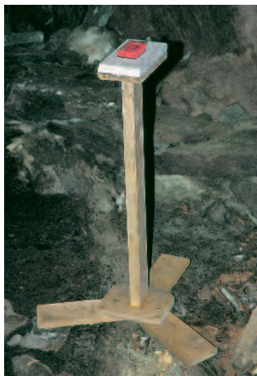
477. Sistemazione del termoisigrometro (apparecchio rosso) nelle cantine.
