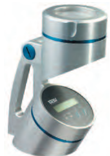
488. Campionatura dell'aria all'uscita di un fiadairöö effettuata con un apparecchio MAS-100 Air Sampler.
