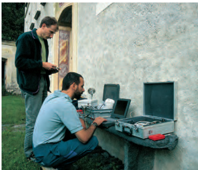
479. Scarico dei dati termoigrometrici registrati dagli strumenti sistemati nelle cantine.
